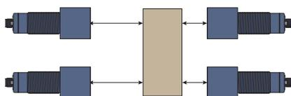
Esta función se puede utilizar para evitar perturbaciones al operar los sensores cara a cara. Se debe asignar una dirección única a cada sensor (o grupo de sensores) con el uso del Software de configuración XX (antes de cablear los sensores), y todos los cables pin.5 (gris) deben estar conectados entre sí. Para la secuenciación con un PLC, comuníquese con el Soporte técnico local de Telemecanique Sensors.
